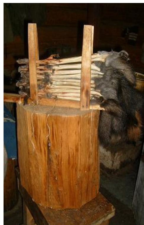
Станок для прессовки шкурки. Фото Марины Кузиной
